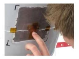
Der klimatisierte **Regenerosionsprüfstand** bietet erstmals die Möglichkeit, die Beständigkeit von Rotorblattbeschichtungen gegen Regenerosion zu bewerten. Die Testbedingungen sind variabel. Umlaufgeschwindigkeiten und klimatische Bedingungen können entsprechend realer Einsatzbedingungen der jeweiligen Rotorblätter individuell eingestellt werden. Es können Modellflügel mit Spitzengeschwindigkeiten bis zu 550 km/h getestet werden. Erste Industrieprojekte werden derzeit bearbeitet.
