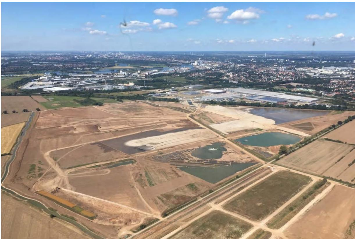
Abbildung 2: Luftfoto der aktuellen flächenhaften Aufhöhung der gesamten Baustufe 2 im GHB sowie des im Zuge dessen in Entwicklung befindlichen Sandentnahmesees
