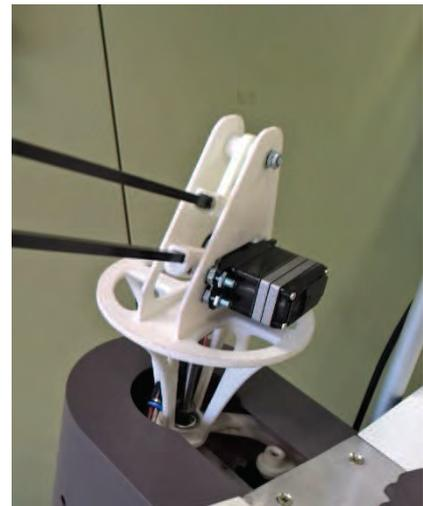
Abbildung 4.26: Die neue Buchhalterung, Mechanik Teile (wie der Trum) sind aus Kunststoff gedruckt.
