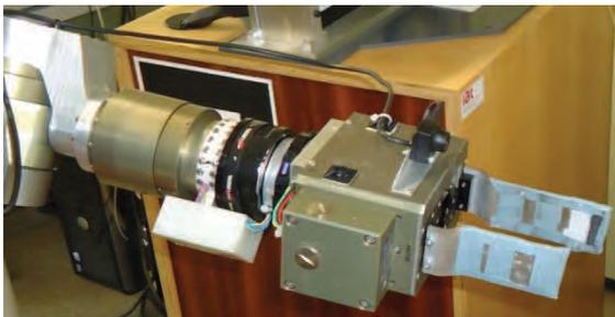
Abbildung 4.18: Handkamera auf Greifer montiert für die Feinkorrektur beim Büchergreifen.
