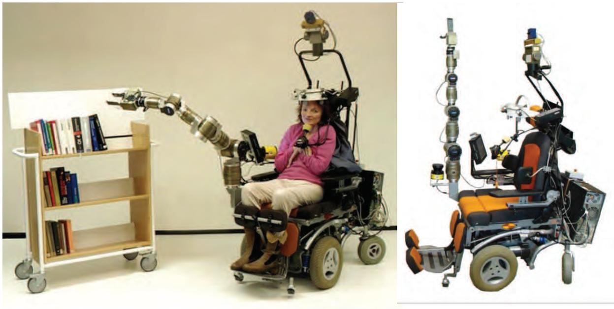
Abbildung 3.1: Der Assistenzroboter FRIEND
