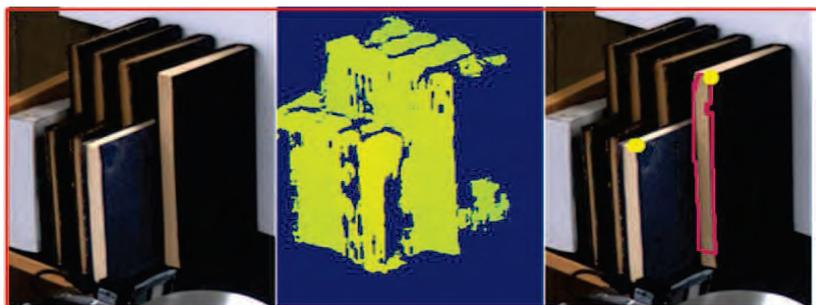
Abbildung 4.21: Mittels der Stereokamera wird das nächste zu greifende Buch auf dem Bücherwagen detektiert.
