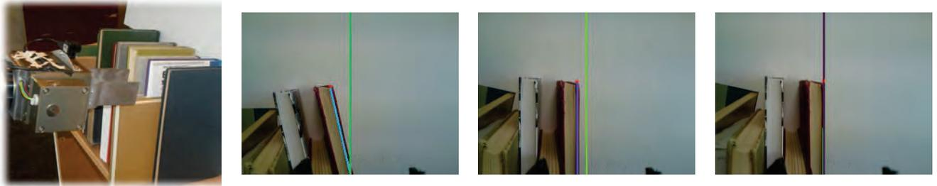
Abbildung 4.22: Mittels der Stereokamera wird das nächste zu greifende Buch auf dem Bücherwagen detektiert (links) und anschließend vom Manipulator gegriffen (rechts).
